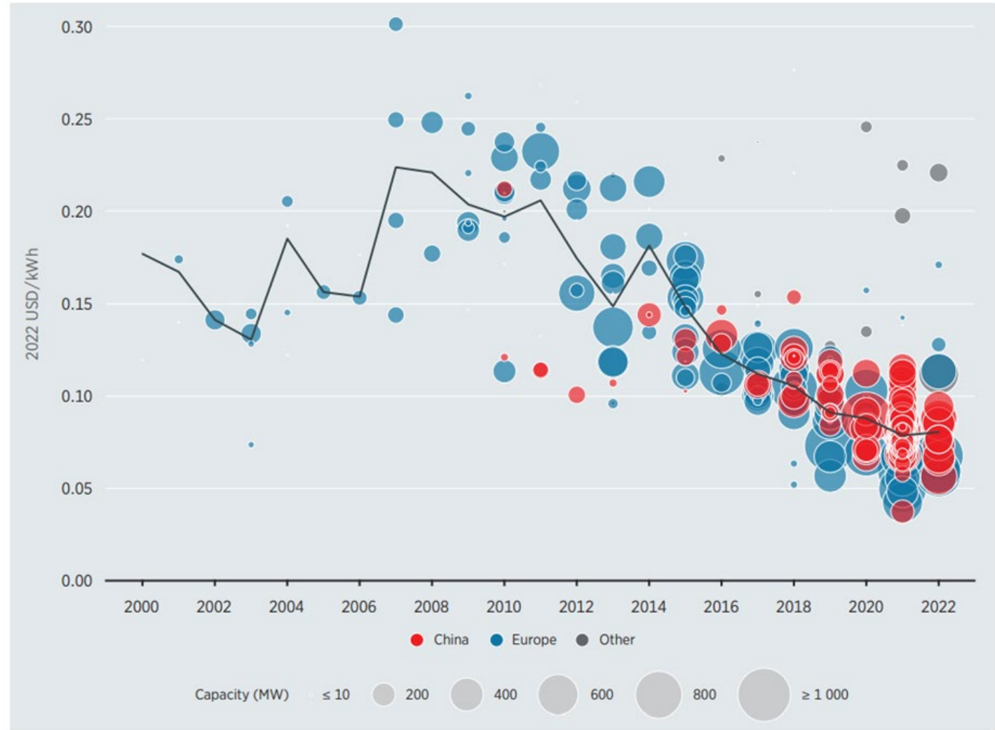
世界の洋上風力発電プロジェクトのサイズとLCOE (加重平均) の推移 出典)IRENA “Renewable Power Generation Costs in 2022”(2023年8月)図4.12
